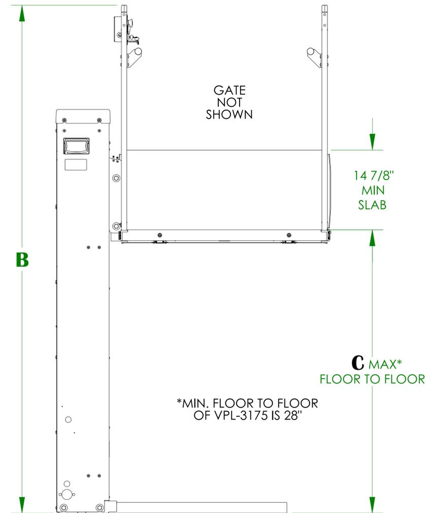
NOTES: 1) ACCESS RAMP & PLATFORM GATE CAN BE MOUNTED ON EITHER SIDE OF THE PLATFORM
