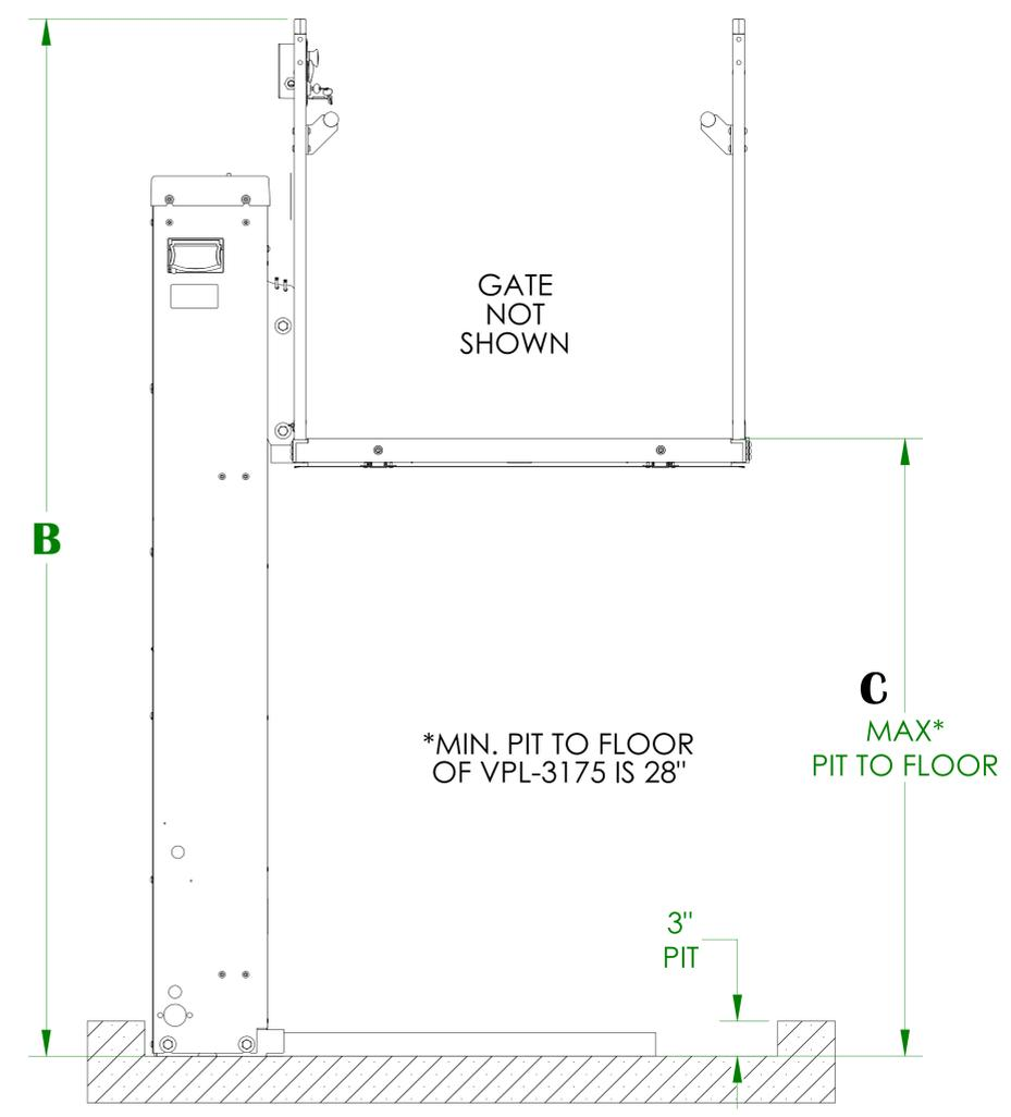
NOTES: 1) PLATFORM GATE CAN BE MOUNTED ON EITHER SIDE OF THE PLATFORM
